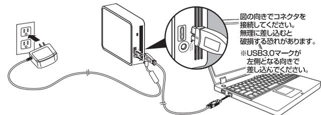
図の向きでコネクタを接続してください。無理に差し込むと破損する恐れがあります。
